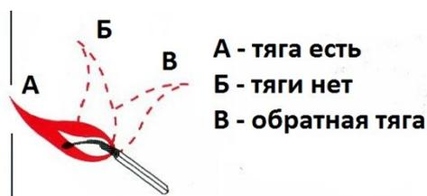
В случае отклонения пламени спички в противоположную сторону (при слабой тяге или её отсутствии), или при погасании пламени («обратная тяга»), пользоваться колонкой или котлом категорически запрещается.
